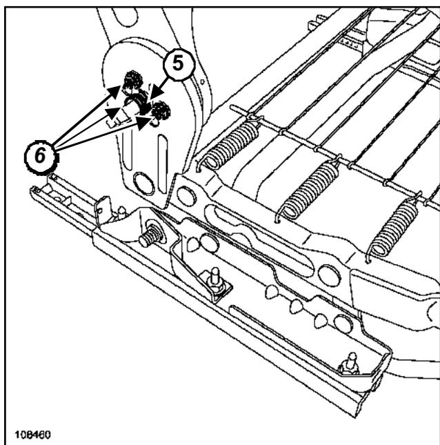
Снимите пружину (5).
