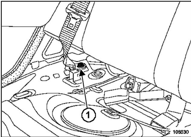
Отверните болты (1) крепления ремней безопасности.
