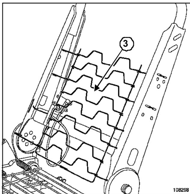
Снимите комплект пружин (3).
