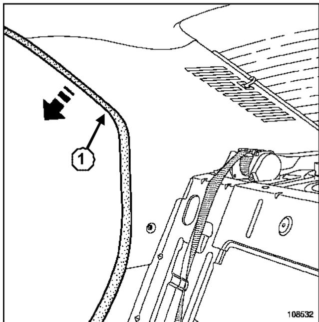
Снимите частично уплотнитель.(1)
