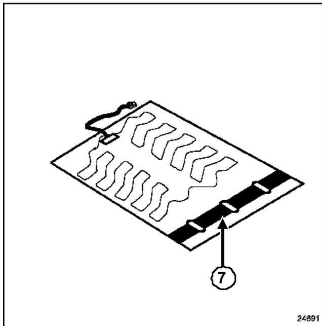
Снимите защитную пленку(7) с нагревательного элемента.
